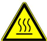
Kurz nach Betrieb des PTC können dieses und die angrenzenden Oberflächen im Gerät noch heiß sein! Verbrennungsgefahr!
