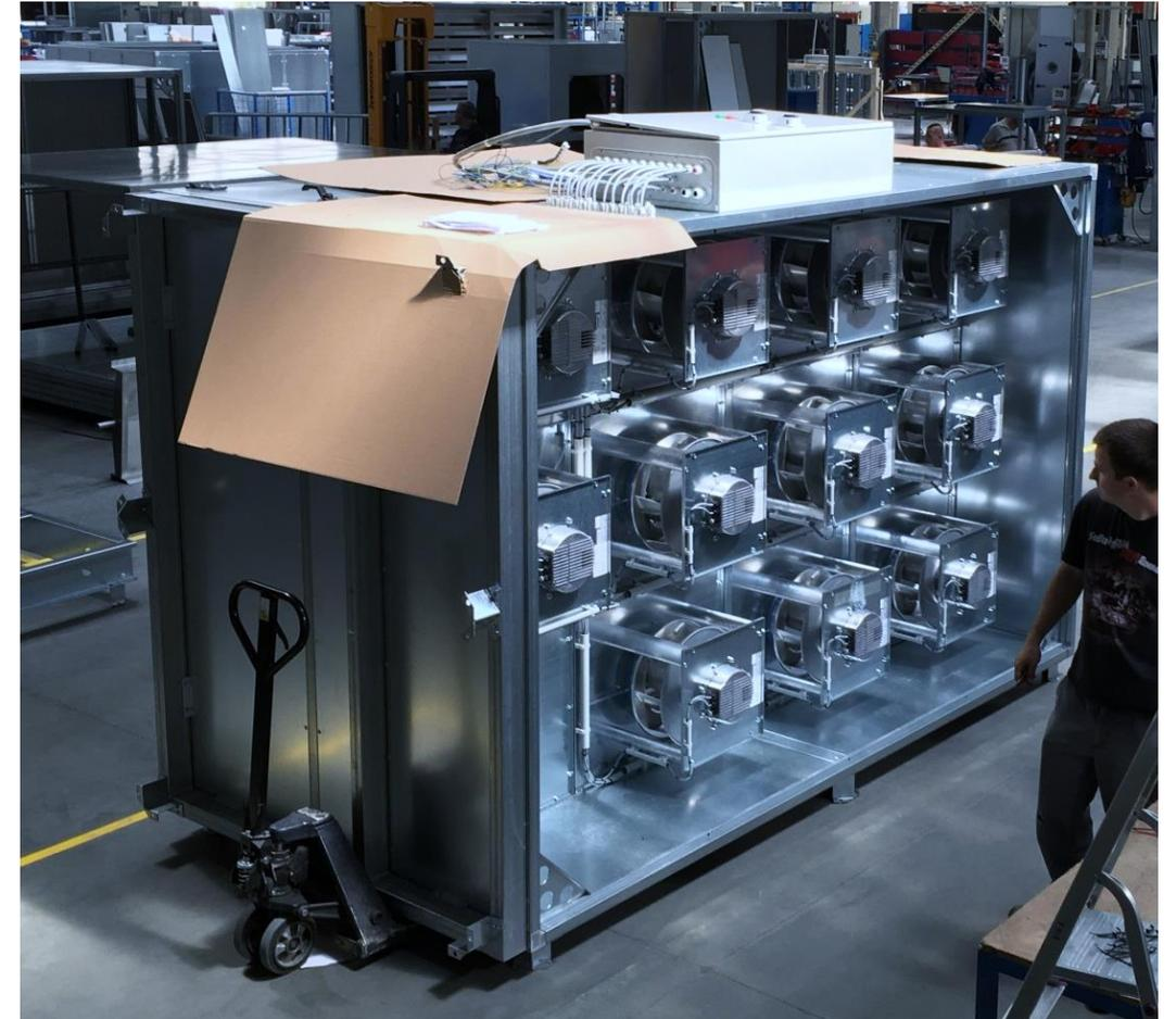
**Gerät wurde aufgrund der Höhe von über 3 m liegend montiert und transportiert.**
