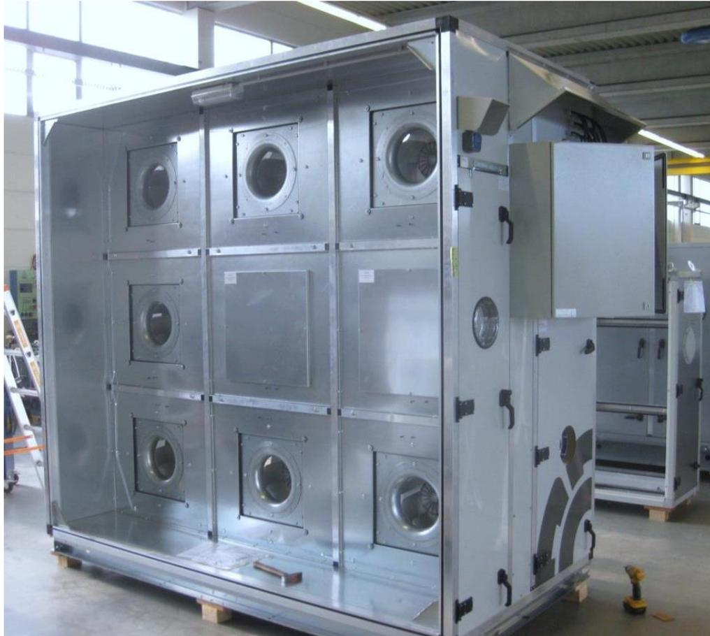
**Saugseitige Ansicht mit angebrachten Verschlussblechen für den Redundanzfall.**
