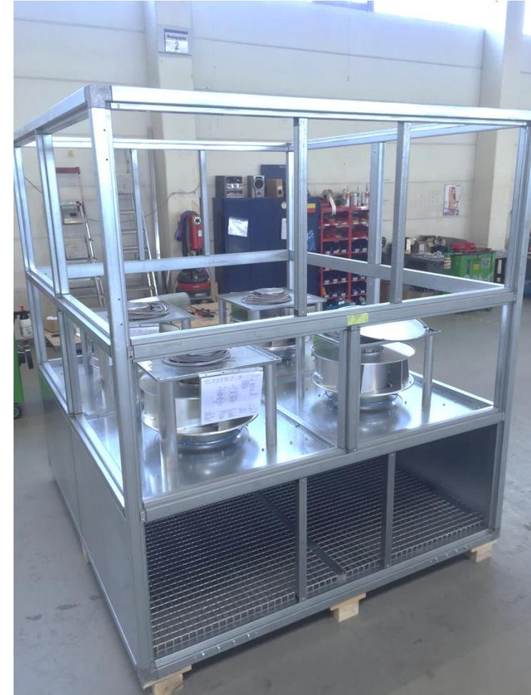
**Lage der 4 Ventilatoren mit Wartungsgitter saugseitig.**
