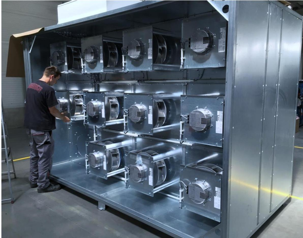
**Druckseitige Ansicht der 11 Ventilatoren**
