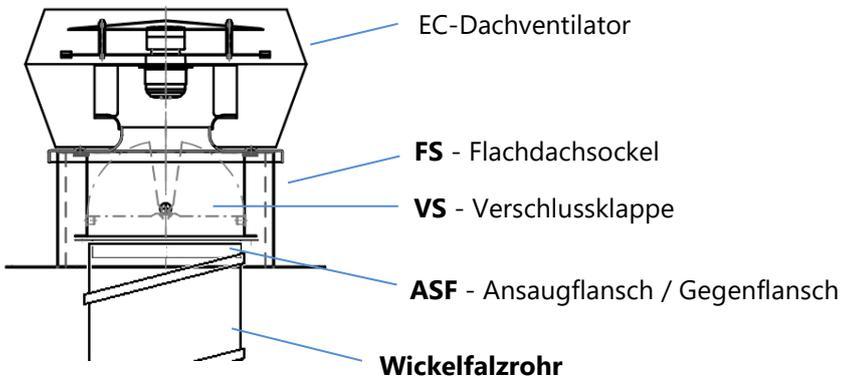
Aufbau in Verbindung mit einem **Sockelschalldämpfer (SD)**
