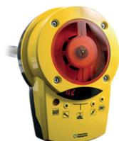
Zur Rauchdetektion in Lüftungskanälen. Mit elektronischer Luftstromüberwachung. Kann direkt als Schaltkontakt an die Regelung angeschlossen werden.
