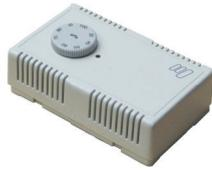
Das Hygroskop kann zur Übersteuerung der Ventilatoren verwendet werden. Beim Überschreiten des eingestellten Sollwertes wird die Lüftung automatisch auf eine einstellbare Drehzahl umgeschaltet und somit der Feuchtegehalt reguliert. Schutzart IP20.
