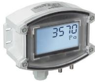
Zur Verwendung bei einer Konstantdruckregelung der Ventilatoren. Mit 0-10 V Ausgangssignal und Spannungsversorgung durch die Regelung. Schutzart IP65.
